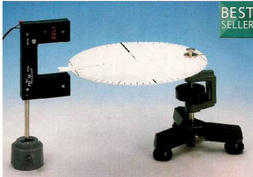
Obr. 2. Měření doby kmitu pro ověření Steinerovy věty.
